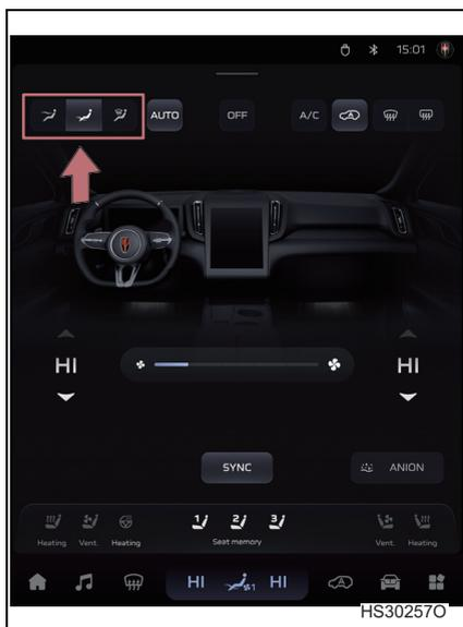
Toque el botón de selección del modo de salida de aire para seleccionar el modo de salida de aire correspondiente, y vuelva a tocarlo para cancelar el modo de salida de aire. Los modos de salida de aire pueden combinarse para su selección.
