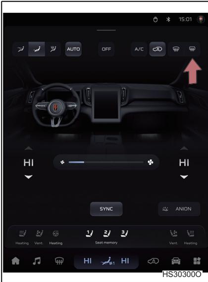
Toque el botón
