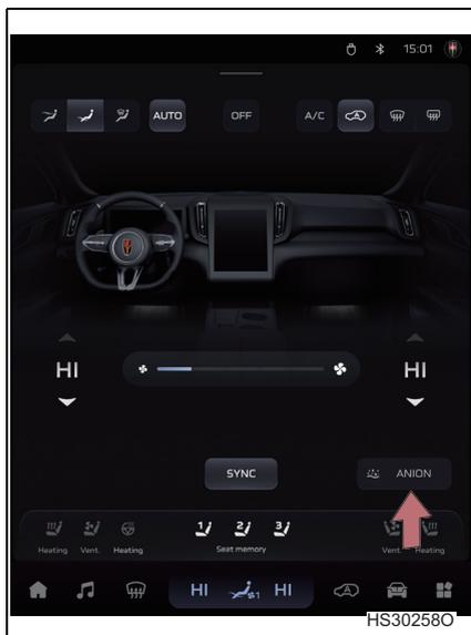
Toque el botón de purificación de aniones en la pantalla; la luz indicadora se encenderá y la función de purificación de aniones se encenderá. Toque el botón nuevamente; la luz indicadora se apagará y la función de purificación de aniones se apagará.
