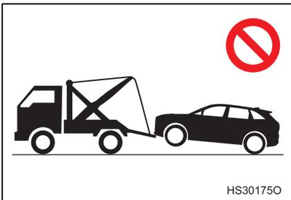
No utilice un camión de remolque con grúa para remolcar, ya que puede dañar la carrocería del vehículo.
