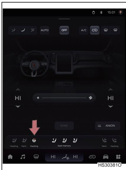
Toque el botón de calefacción del volante en la interfaz de ajuste del A/C de la pantalla multimedia; el botón se iluminará y la función de calefacción del volante se activará. Toque el botón nuevamente y la función de calefacción del volante se apagará.
