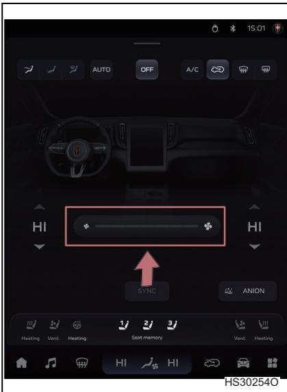
Opere el botón de ajuste de volumen de aire en la pantalla o arrastre la barra de ajuste de volumen de aire para regular el caudal de aire del sistema de A/C del vehículo entre los niveles 1-7.
