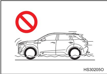
En caso de conducir por una carretera inundada, es probable que ocurra un apagado del motor, un cortocircuito en los componentes eléctricos y la entrada de agua. No intente arrancar el motor después de un apagado, de lo contrario esto podría dañar gravemente el motor.
