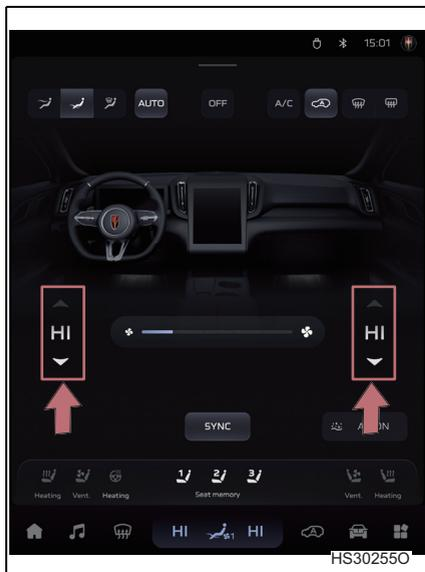
Toque el botón de ajuste de la temperatura  $\wedge$  (subir) o  $\vee$  (bajar) en la pantalla para configurar la temperatura, o deslice el valor de la pantalla de temperatura arriba y abajo para configurar la temperatura.
