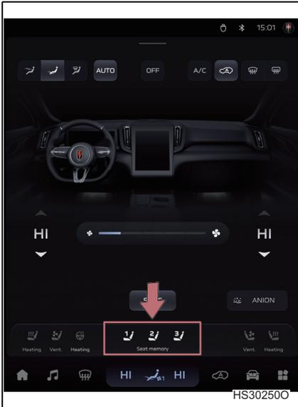
Para ajustar el contenido de la memoria: Después de ajustar la posición del asiento y del espejo retrovisor exterior, mantenga presionado cualquier botón de memoria (durante más de 3 segundos). Suelte el botón después de escuchar el tono de aviso del cuadro de instrumentos, y la información de la posición quedará memorizada.
