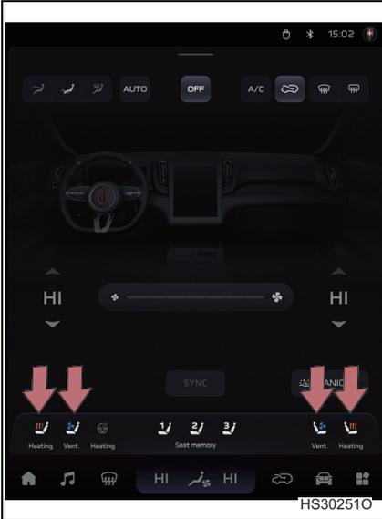
Toque el botón de calefacción y ventilación del asiento en la interfaz de ajuste del A/C de la pantalla multimedia para seleccionar el nivel apropiado de calefacción y ventilación.
